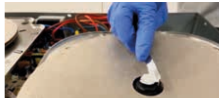
Apply the conductive thermal paste on the sensor. Applicare la pasta termica sui sensori del sistema.
